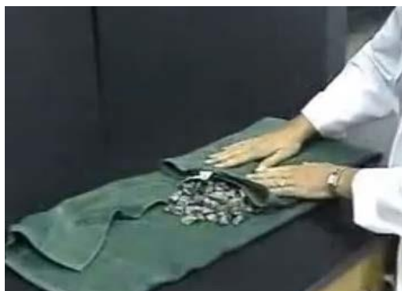
Figura 223 - 2. Secado superficial de la muestra
